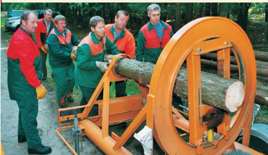
Bild oben: Die Baumstämme sollten eine Länge zwischen 4 und 7,50 m und einen Durchmesser bis zu 24 cm haben. So sind mehrere Schnitte möglich.
